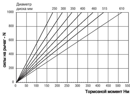
Максимальное тормозное усилие = 8.3кН@ 0.9кН силы на рычаг
