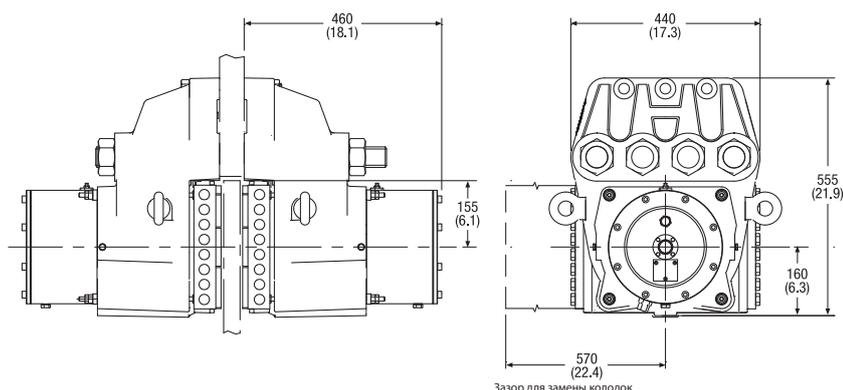
Дисковый тормозной суппорт Twiflex VMS3-SPS состоит из двух модулей, прикрепленных болтами к центральной монтажной пластине, которая на 12 мм толще, чем диск. Минимальная толщина диска составляет 38 мм, а минимальный диаметр - 1500 мм, без ограничения по максимальной цифре. Основанный на инновации предыдущего дискового тормоза VMS2-SP Twiflex VMS3-SPS обеспечивает существенное увеличение тормозного усилия, а по размеру остается прежним.
