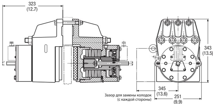
Дисковый тормозной суппорт Twiflex VKSD состоит из двух половин или пружинных модулей и подходит для использования с диском минимальной толщиной 20 мм. Модули монтируются на каждой стороне центральной установочной пластины, имеющей толщину на 12 мм больше толщины диска. Минимальный диаметр диска составляет 1000 мм.
