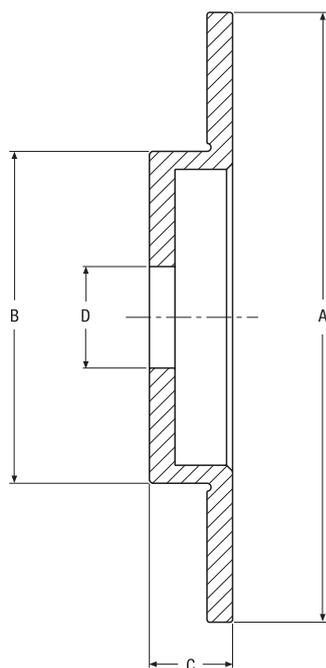
Тормозные диски Twiflex могут поставляться расточенными и просверленными по запросу покупателя. Нестандартные размеры диска, не показанные в таблицах, могут поставляться по заказу. Тормозные диски производятся из чугуна с шаровидным графитом.
