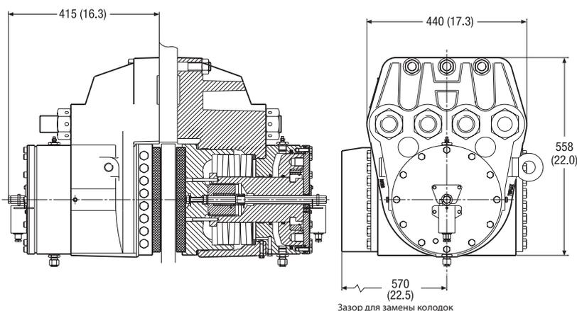
Дисковый тормозной суппорт Twiflex VMS2 состоит из двух модулей, прикрепленных болтами к центральной монтажной пластине, которая на 12 мм толще, чем диск.
