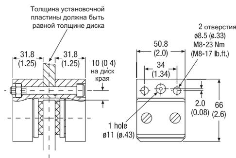
Дисковый тормозной суппорт Twiflex T2 имеет расщепленную форму и подходит для использования с диском минимальной толщиной 5 мм. Модули монтируются на каждой стороне центральной установочной пластины, имеющей толщину равную толщине диска. Минимальный диаметр диска составляет 120 мм. Альтернативно тормоз может устанавливаться по сторонам пластины на расстоянии равном толщине диска между двух половин.
