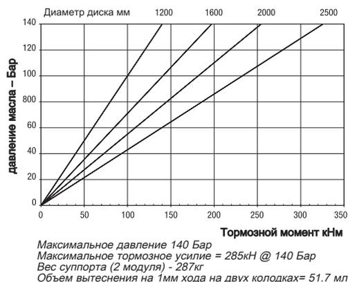
Дисковый тормозной суппорт Twiflex VH состоит из двух модулей, защищенных от U-образной вершины до нижних монтажных пластин с помощью анкерных болтов.
