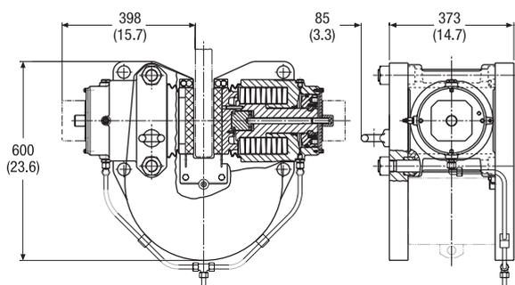
Дисковый тормозной суппорт Twiflex VS Mk2 состоит из двух модулей, защищенных от U-образной вершины до нижних монтажных пластин с помощью анкерных болтов.
