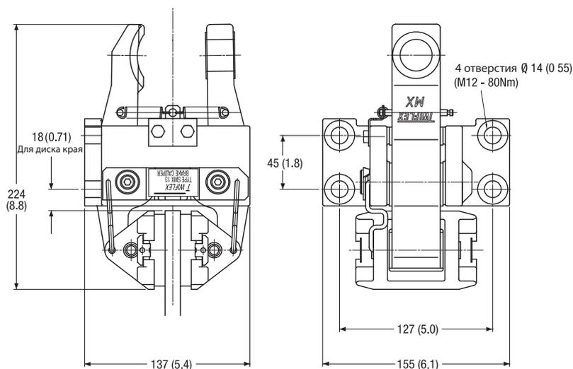
Давление растормаживания рассчитано и может изменяться в зависимости от допустимого предела пружины.
