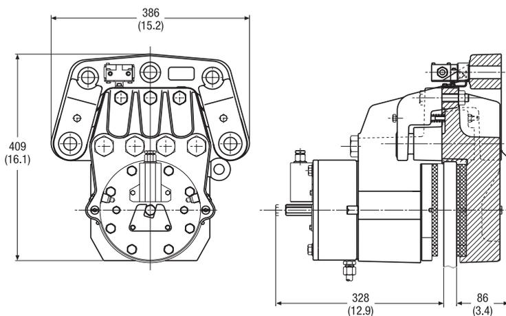
Дисковый тормозной суппорт Twiflex VKSD-FL включает в себя пружинный модуль, формирующий 'активную' сторону этой плавающей модели, и доступен для использования там, где пространство ограничено или для компенсирования осевого плавления диска на  $\pm 6$  мм.
