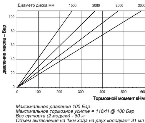
Дисковый тормозной суппорт Twiflex VMH2 состоит из двух модулей, прикрепленных болтами к центральной монтажной пластине, которая на 12 мм толще, чем диск.
