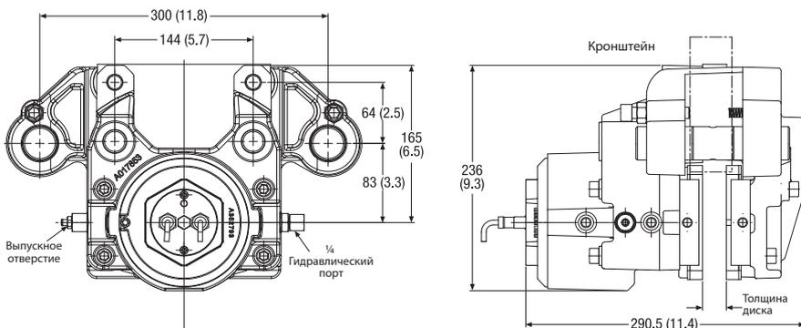
Дисковый тормозной суппорт Twiflex VKCS-FL включает в себя пружинный модуль, формирующий 'активную' сторону этой плавающей модели, и доступен для использования там, где пространство ограничено или для компенсации осевого плавления диска на  $\pm 6$  мм.
