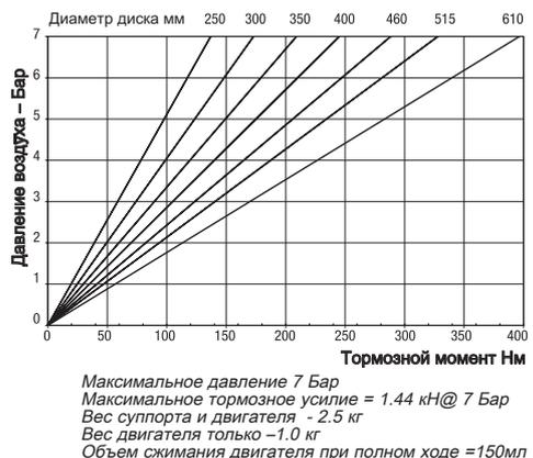
Давление растормаживания рассчитано и может изменяться в зависимости от допустимого предела пружины.
